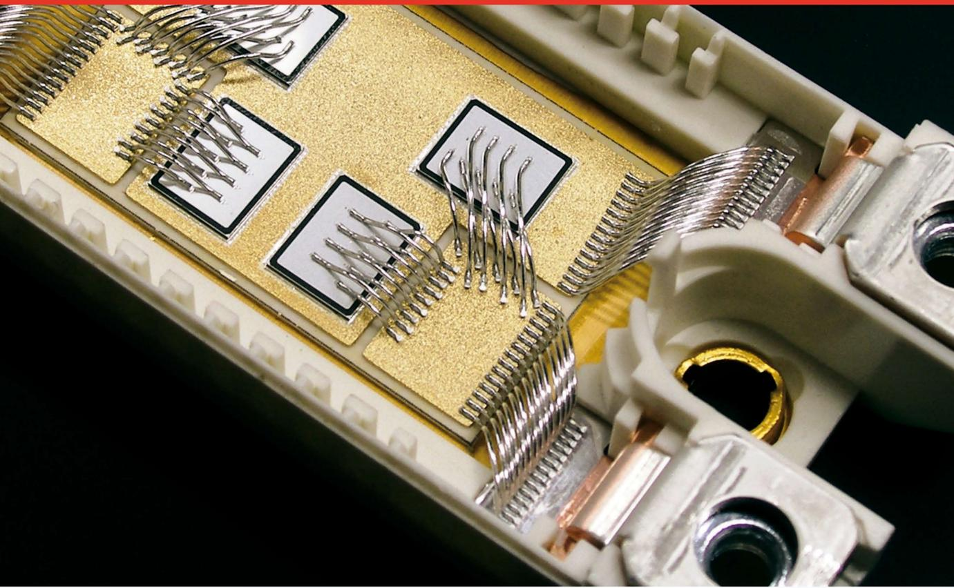
Hier wird nicht geklebt oder gelötet, sondern mit Hilfe von Nanotechnologie verbunden. Erster industriegerechter Demonstrator eines sog. gesinterten Diodenmoduls.
