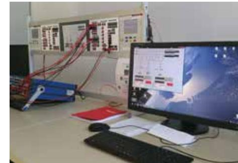
Abbildung 1 Simulation und Visualisierung einer Mittelspannungsschaltanlage auf Basis IEC61850
